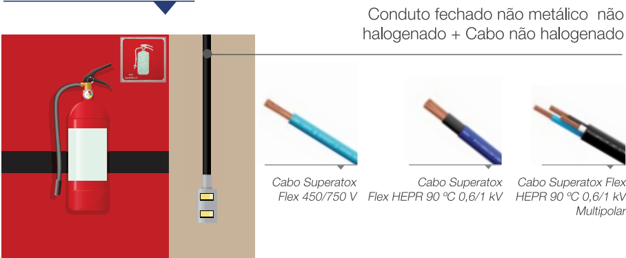
Figura 7: Linhas aparentes com condutos fechados não metálicos em locais de afluência de público
