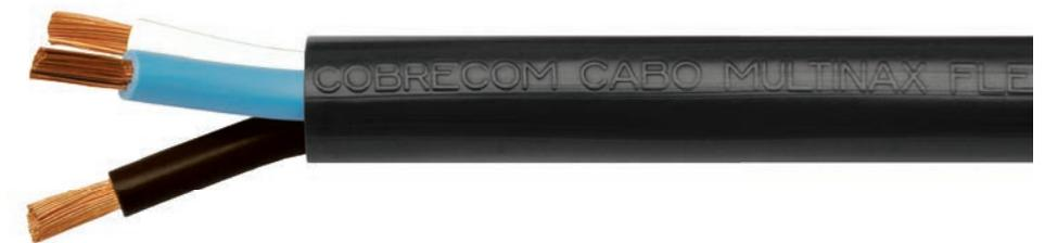
Para tensões nominais até 0,6/1 kV, formado por fios de cobre nu, eletrolítico, têmpera mole, encordoamento classes 4 e 5 (flexíveis), as veias são isoladas com Policloreto de Vinila (PVC), tipo PVC/A para 70°C torcidas entre si, formando o núcleo, e cobertura extrudada com Policloreto de Vinila (PVC), tipo ST 1, antichama (BWF-B).
