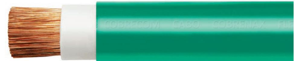
Para tensões nominais até 0,6/1 kV, formado por fios de cobre nu, eletrolítico, têmpera mole, encordoamento classes 4 e 5 (flexíveis), isolado com Policloreto de Vinila (PVC), tipo PVC/A para 70°C, antichama (BWF-B) e cobertura de Policloreto de Vinila (PVC), tipo ST 1, antichama (BWF-B).
