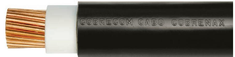
Para tensões nominais até 0,6/1 kV, formado por fios de cobre nu, eletrolítico, têmpera mole, encordoamento classe 2, isolado com Policloreto de Vinila (PVC), tipo PVC/A para 70°C, antichama (BWF-B) e cobertura de Policloreto de Vinila (PVC), tipo ST 1, antichama (BWF-B).
