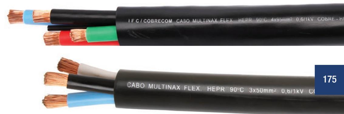
Para tensões nominais até 0,6/1 kV, formado por fios de cobre nu, eletrolítico, têmpera mole, encordoamento classes 4 e 5 (flexíveis), isolado com composto termofixo Etileno Propileno (HEPR), de alto módulo para 90°C, veias torcidas entre si, formando o núcleo, a cobertura extrudada com Policloreto de Vinila (PVC), tipo ST 2, antichama (BWF-B).
