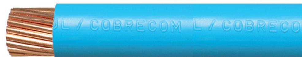
Para tensões nominais até 450/750 V, formado por fios de cobre nu, eletrolítico, têmpera mole, encordoamento classe 2, isolado com Policloreto de Vinila (PVC), tipo PVC/A para 70°C, antichama (BWF-B).
